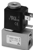
La electroválvula 3/2 vía NC, con conexiones de G1/8, ha sido realizada con una pequeña descarga rápida incorporada. Es particularmente apta para el accionamiento de pequeños cilindros de simple efecto.
