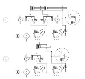
ESQUEMA DE FUNCIONAMIENTO 1: descarga de la superpresión en la cámara de un cilindro o en un depósito cuando sea superado el valor programado.
