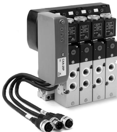
En la versión Multipolar la posición frontal del conector Sub-D de 25 pins hace la conexión más fácil. Los conectores con cable pre alambrado, que están disponibles en diferentes longitudes con orientación radial o axial, simplifican la conexión eléctrica. La isla puede ser configurada hasta un máximo de 22 bobinas, usando módulos eléctricos monoestables y biestables en 22 posiciones de válvulas, por ejemplo 22 electroválvulas monoestables.
